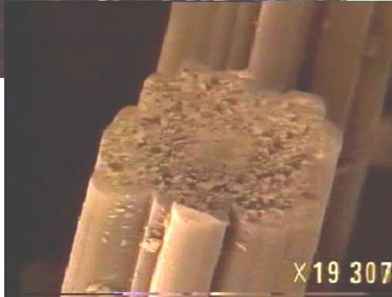
Fibres de carbone enrobées dans une matrice époxy (1-10 \mu\text{m} )
